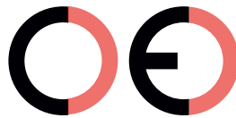
Falsche CE-Kennzeichnung (zu großer Zwischenraum)
